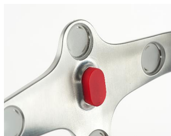
Ejemplo de la colocación de los marcadores reflectivos en las carcasas del captador frontal.
